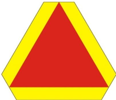
"Тихоходное транспортное средство" - выглядит в виде равностороннего треугольника с флюоресцирующим покрытием красного цвета и со световозвращающей каймой желтого или красного цвета (длина стороны треугольника от 350 до 365 мм, ширина каймы от 45 до 48 мм). Устанавливается сзади механических транспортных средств, для которых предприятием-изготовителем установлена максимальная скорость не более 30 км/ч.
