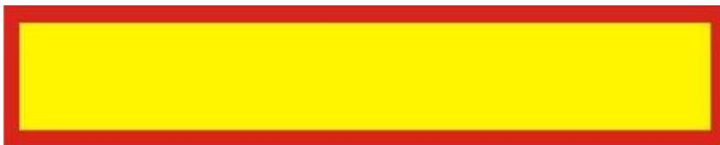
Изготавливается в виде прямоугольника размером не менее 1200 X 200 мм желтого цвета с каймой красного цвета (ширина 40 мм), имеющего световозвращающую поверхность - сзади транспортных средств, длина которых с грузом или без груза более 20 м, и автопоездов с двумя и более прицепами. При невозможности размещения знака указанного размера допускается установка двух одинаковых знаков размером не менее 600 X 200 мм симметрично оси транспортного средства.
