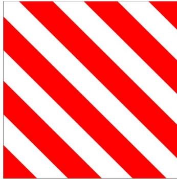
Изготавливается в виде щитка размером 400 X 400 мм с нанесенными по диагонали красными и белыми чередующимися полосами шириной 50 мм со световозвращающей поверхностью. ГОСТ Р12.4.026-2001
